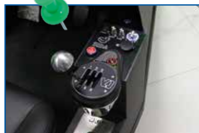
Pulsante 4 frecce, porta USB esterna, uscita AUX, amplificatore stereo
