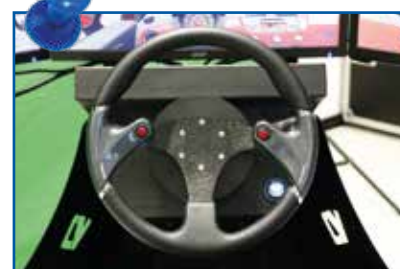
Volante reale da 35 cm, Forcefeedback, 90° di rotazione a 2 pulsanti
